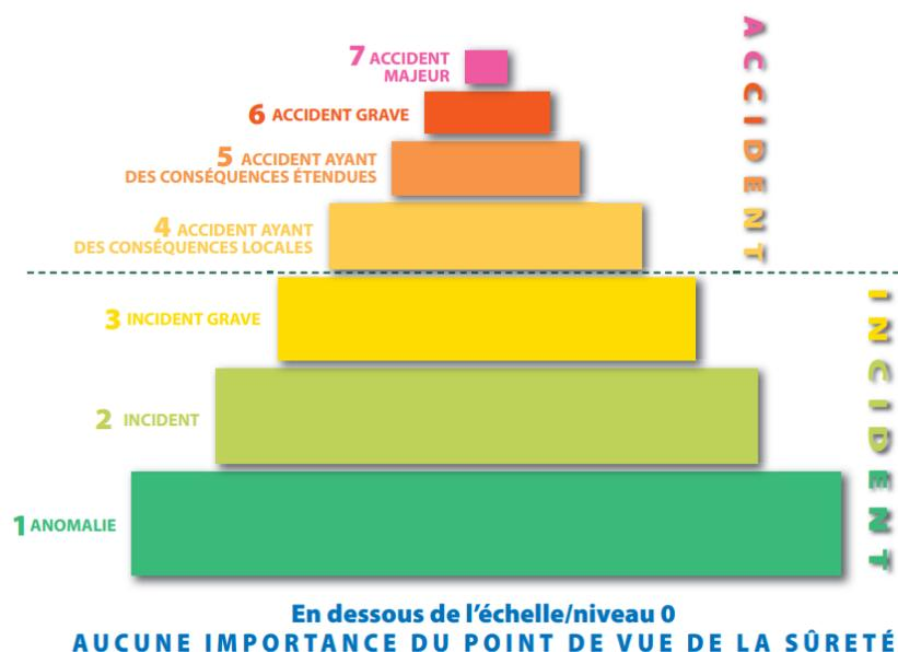
Figure 1 : Échelle internationale INES de gravité d'un incident ou d'un accident nucléaire [Source : AIEA].
