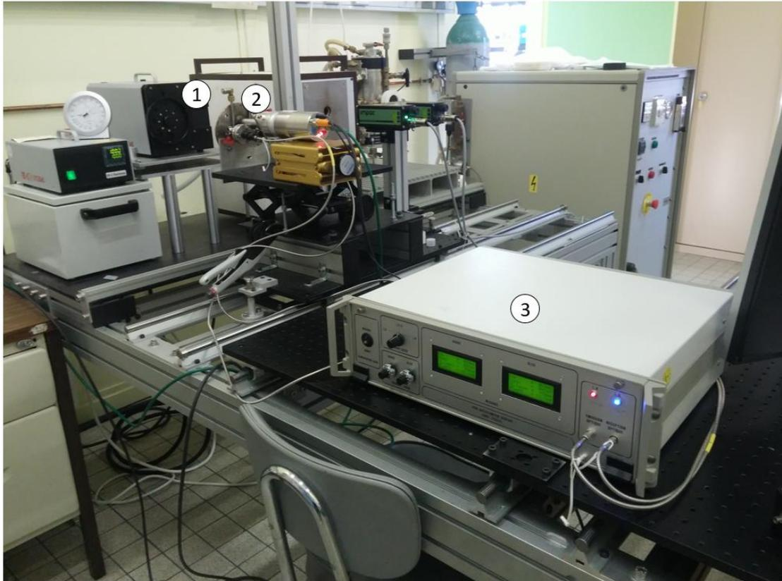
Figure 5.10 : Réglage de la tête optique (2) du pyroréfectomètre (3) devant un corps noir à diaphragme réglable (1) du laboratoire PROMES.
