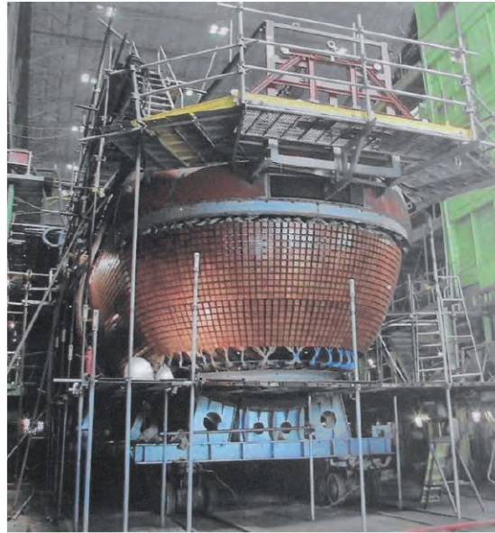
FIGURE 1.4 – Antenne de l'avant d'un sous-marin classique russe au chantier (extrait de [Pillon, 2016]).
