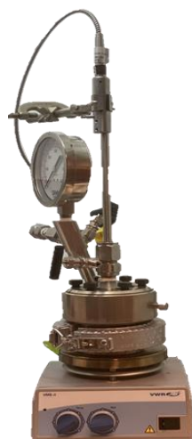
Figure 7 : Dispositif de caractérisation par spectroscopie Raman-Operando en phase liquide.
