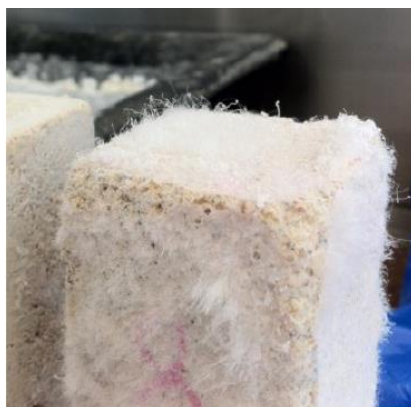
Figure 1.41 : Efflorescences à la surface des éprouvettes conservées dans l'eau [176].
