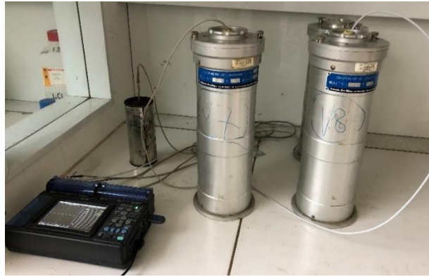
Figure 2.11 : Dispositif de mesure de la chaleur d'hydratation : Calorimètres de Langavant.
