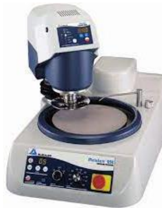
Figure 2.24 : Polisseuse semi-automatique Metaserv 250 BUEHLER.
