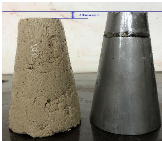
Figure 2.9 : Essai d'affaissement au mini-cône.
