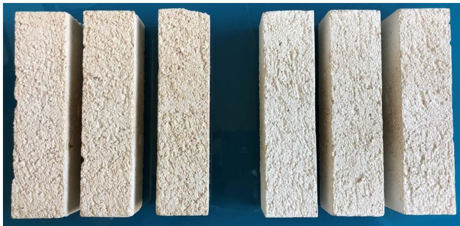
Figure 4.24 : Aspect des échantillons de mortiers après essai de lixiviation (immersion et séchage) : gauche formulation sans verre, droite formulation avec verre.
