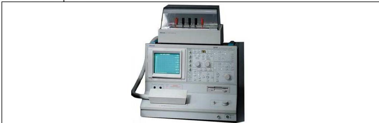
Figure 1 - Image du traceur Tektronix 371A associé à son boîtier de connexion.
