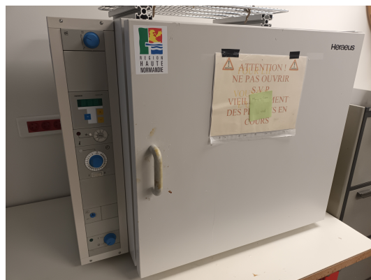
Figure 3.9 – Four de cuisson utilisé pour la dépolarisation de la plaque phononique.
