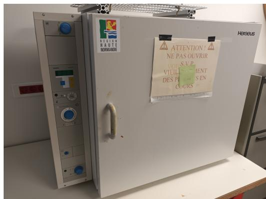
**Figure 3.9** – Four de cuisson utilisé pour la dépolarisation de la plaque phonique.
