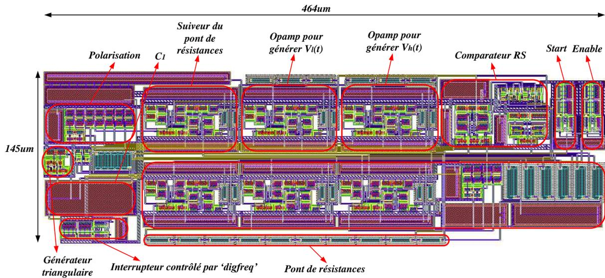
Figure 4.15 : Vue Layout du générateur de porteuse complet.
