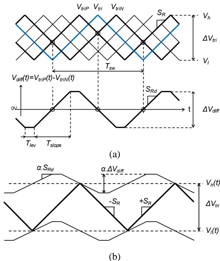
Figure 2.1 : a) Dispositif à cinq porteuses correctement entrelacées. Le signal  $V_{diff}(t)$  représente la différence entre la porteuse précédente  $V_{triP}$  et la porteuse suivante  $V_{triN}$ ; b) Principe : Le signal  $V_{diff}(t)$  est superposé aux seuils  $V_h$  et  $V_l$  et guide ainsi en phase la génération de  $V_{tri}$ .
