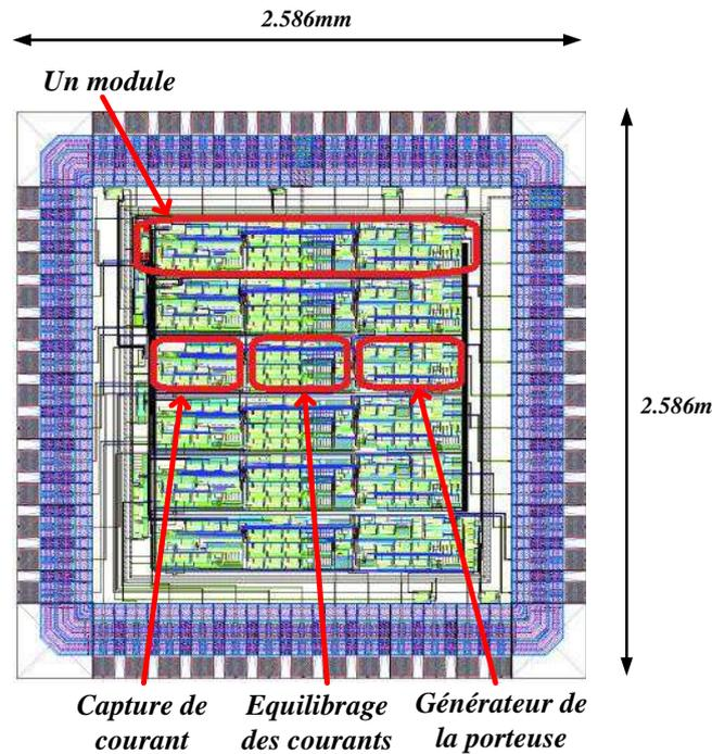
Figure 4.30 : Vue Layout de l'ASIC final ( $6.8\text{mm}^2$ ).
