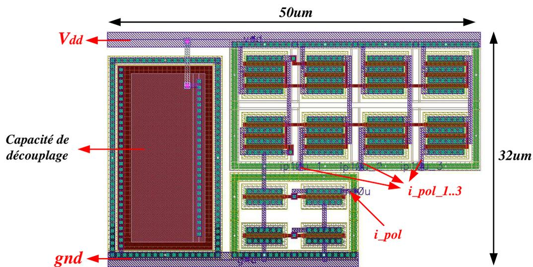
Figure 4.3 : Vue Layout du circuit de polarisation.
