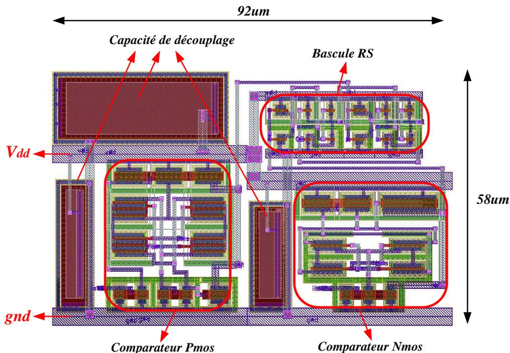
Figure 4.13 : Vue Layout du trigger de Schmitt.
