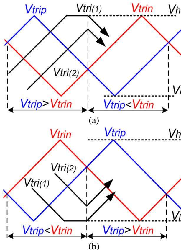
Figure 2.11 : Analyse du comportement du signal généré dans les cas d'avance et de retard de phase (cas  $V_{tri}(1)$  et  $V_{tri}(2)$ ) : a) Signal ascendant ; b) Signal descendant.
