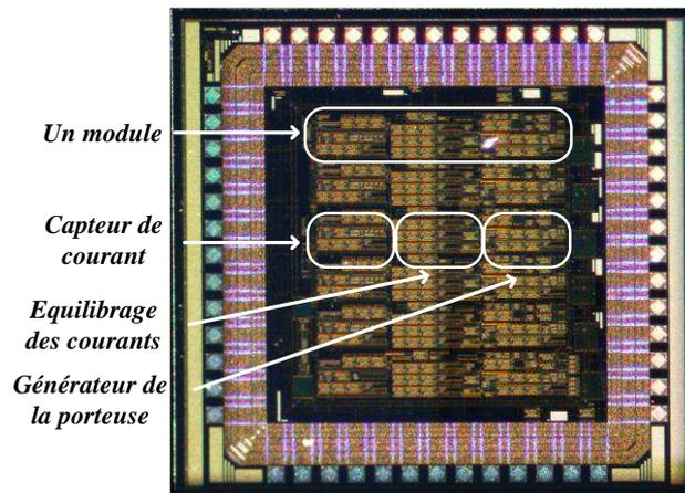
Figure 4.32 : Photo de l'ASIC final (technologie AMS CMOS 0,35um, 6.8mm<sup>2</sup>).
