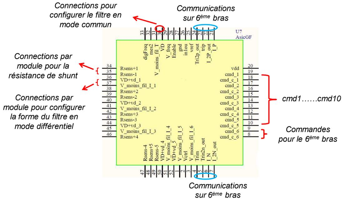
Figure 4.31 : Interfaces d'entrée/sortie de la puce.
