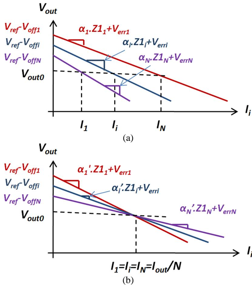
Figure 3.8 : Caractéristique de sortie: a) sans correction de pente b) avec correction de pente.
