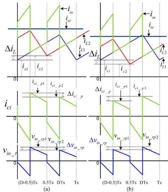
Figure 1.17 : Formes d'onde des courants de branche, de leur différence et de la composante alternative de la tension d'entrée : (a)  $i_{L2} > i_{L1}$ ; (b)  $i_{L2} < i_{L1}$  ( $i_{in}$  : courant d'entrée,  $i_{L1}$  et  $i_{L2}$  : courants des branches,  $i_{ci}$  : courant de la capacité d'entrée,  $V_{in\_r}$  : composante alternative de la tension d'entrée)
