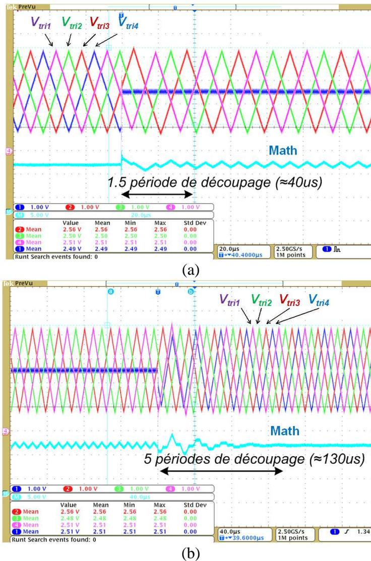
Figure 2.10 : Test de reconfiguration du nombre de porteuses entrelacées ; (a) Passage de 4 porteuses à 3 ( $20\mu\text{s}/\text{div}$ ,  $1\text{V}/\text{div}$ ); (b) Passage de 3 porteuses à 4 ( $10\mu\text{s}/\text{div}$ ,  $1\text{V}/\text{div}$ ).
