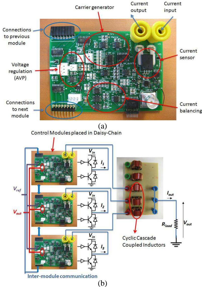
Figure 3.13 : a) Carte d'évaluation CMS d'un module implémentant les trois fonctions principales (dimensions  $8.0 \times 5.5 \text{ cm}^2$ ) ; b) Convertisseur parallèle utilisant 3 modules de contrôle connectés dans une configuration chaînée ( $V_{in}=12V$ ;  $V_{out}=1V$ ;  $I_{out}=15A$ ;  $F_{sw}=40KHz$ ).
