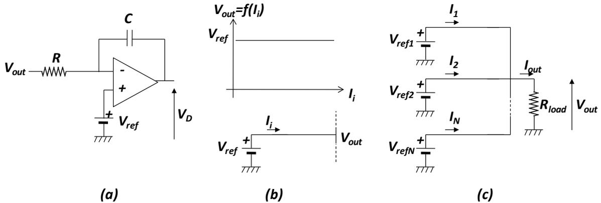
Figure 3.5 : a) Circuit de régulation classique; b) Caractéristique de sortie d'un bras et schéma équivalent Thévenin; (c) Circuit équivalent du convertisseur parallèle à  $N$ -bras.
