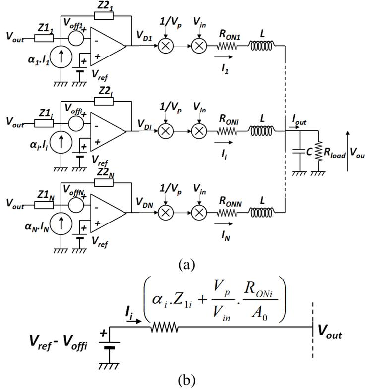
Figure 3.7 : Régulation de tension décentralisée : a)  $N$  régulations de type AVP en parallèle b) Schéma équivalent Thévenin du  $i^{\text{ème}}$  bras.
