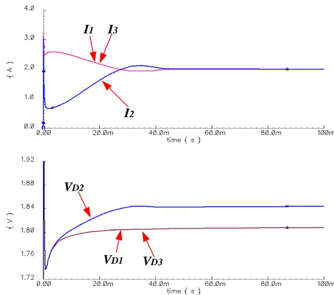
Figure 4.21 : Simulation du correcteur différentiel : convertisseur à 3 bras,  $V_{ref}=3V$ ,  $R_{ch}=0.5\Omega$  et une résistance de 30mΩ est ajoutée sur le bras 2 pour créer un déséquilibre.
