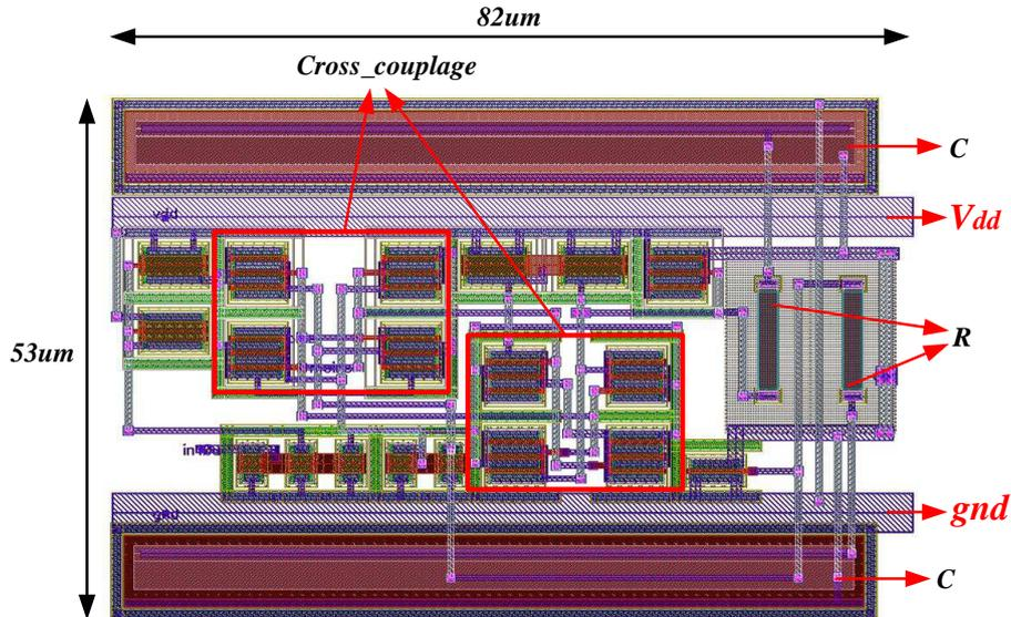
Figure 4.6 : Vue Layout de l'amplificateur opérationnel.
