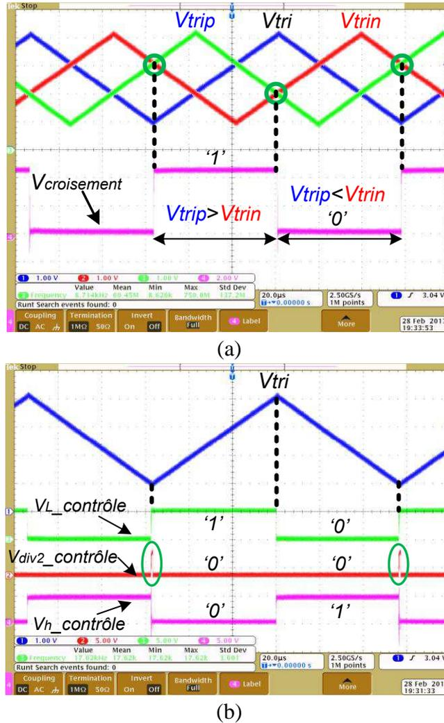
Figure 2.18 : Test de la génération des porteuses entrelacées dans un cas à  $N=3$  : a) Pentes de  $V_{tri}$  fonction du croisement de  $V_{trip}$  et  $V_{trin}$ ; b) Comportement des bits de contrôle.
