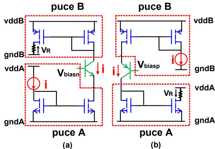
Figure 1.4 : Transmission d'un signal entre deux puces A et B référencées à des potentiels différents :
