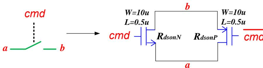
Figure 4.26 : Interrupteur de l'échantillonneur-bloqueur réalisé en technologie CMOS.
