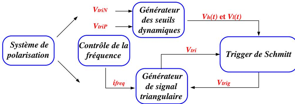
Figure 4.9 : Fonctions internes du générateur de porteuse auto-alignée.
