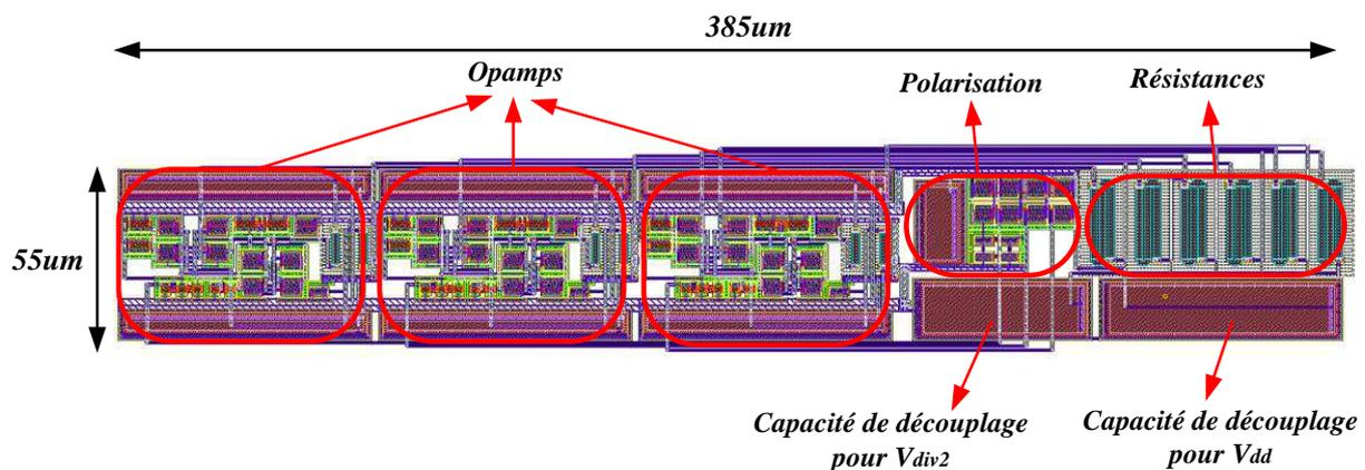
Figure 4.8 : Vue Layout de l'amplificateur d'instrumentation.
