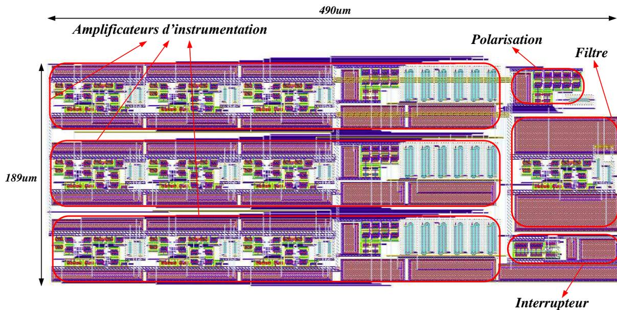
Figure 4.22 : Vue Layout du circuit d'équilibrage des courants.
