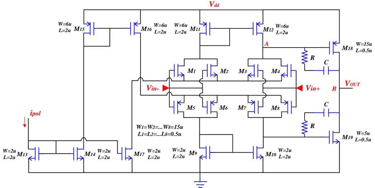
Figure 4.4 : Amplificateur opérationnel « rail-to-rail » en technologie CMOS.
