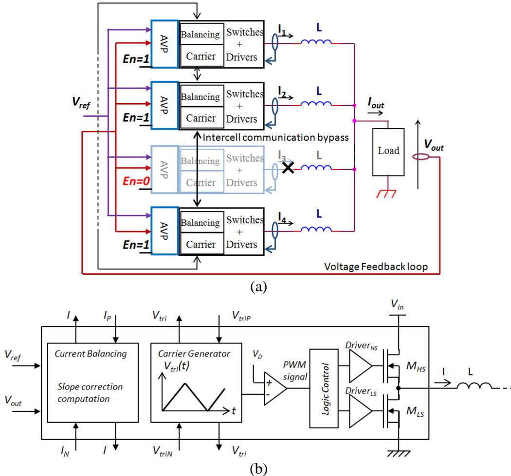
Figure 3.12 : Reconfiguration du système en connectant les modules voisins entre eux : a) Le module 3 est enlevé; b) Eléments internes au modules et ports de communication ( $V_{trip}$ : porteuse précédente,  $V_{trin}$ : porteuse suivante,  $V_{tri}$ : porteuse du module; idem pour les courants).
