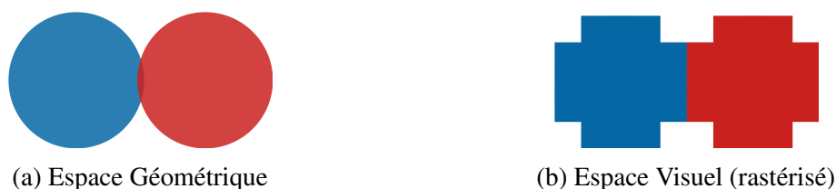
FIGURE IV.9 : Illustration d'un chevauchement dans (a) l'Espace Géométrique. Ce chevauchement n'est plus visible une fois rastérisé dans une grille de pixels (b). L'objectif de GIST est de tirer parti de cet effet.
