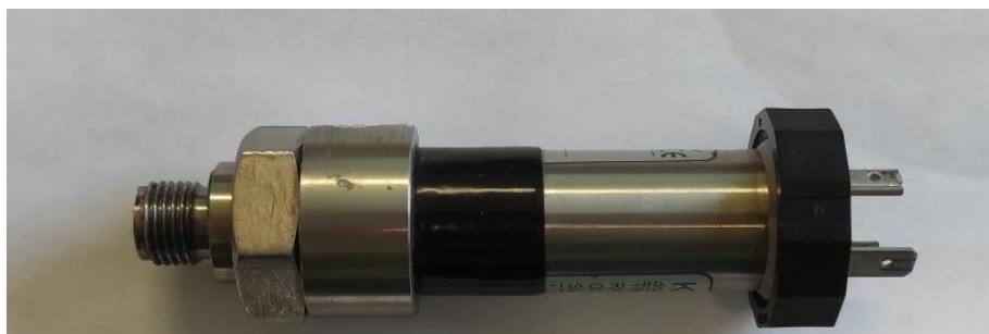
Figure 46 : Photographie d'un capteur de pression statique de la marque Keller® modèle PAA-23.
