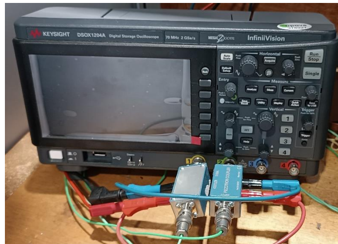
Figure 50 : Oscilloscope numérique DSOX1204A utilisé pour la visualisation des signaux de pression en écoulement oscillant avec les conditionneurs connectés.
