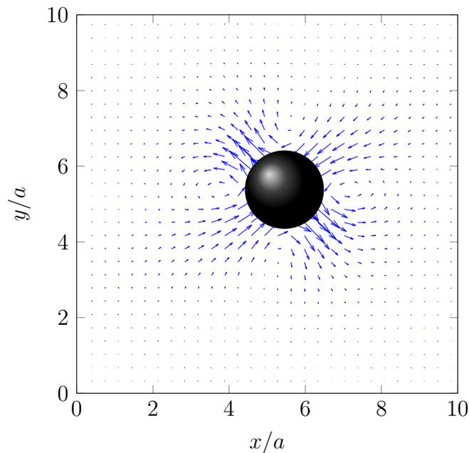
FIGURE 1.5: Représentation du champ des perturbations de vitesse ( $\vec{u}' + \vec{v}'$ ) dans un plan  $(xy)$  traversant la particule. Mise en évidence de la perturbation induite par la particule lorsqu'elle est placée en présence d'un cisaillement.
