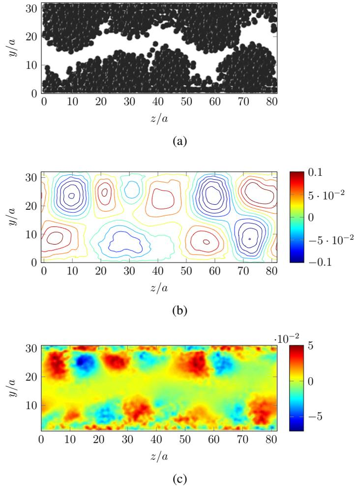
FIGURE 2.11: Suite à la stratification de l'écoulement de suspension ( $Re = 1400$ ), une instabilité se développe dans la direction de la vorticité  $z$  induisant l'apparition de motifs sous forme de dunes (a). (b) : Contours de la fluctuation de vitesse longitudinale moyennée selon  $x$ . (c) : Contours du rotationnel de vitesse dans la direction de l'écoulement moyenné sur un intervalle de temps égal à  $70H / \langle U \rangle$  une fois que les motifs dunaires ont pris place.
