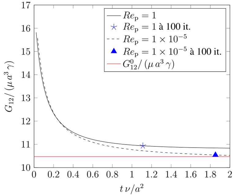
FIGURE 2.1: Évolution de la composante de cisaillement  $G_{12}/(\mu \gamma a^3)$  en fonction de  $t\nu/a^2$  dans un écoulement cisailé pur, à différents  $Re_p$  ( $G_{12}^0 = 10\pi/3$ ). Deux domaines bornés de dimensions  $(20a)^3$  pour les cas à  $Re_p = 10^{-5}$  et  $(10a)^3$  pour le cas à  $Re_p = 1$  ont été utilisés. La résolution du maillage est de 3 mailles par rayon de particule. Les symboles sur les courbes (\* et ▲) indiquent la valeur du Stresslet à 100 itérations.
