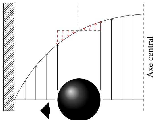
FIGURE 2.6: Portance exercée sur une particule sphérique rigide et non-pesante au sein d'un écoulement à profil de vitesse parabolique (d'après Matas *et al.* (2004)). De façon analogue à la force de Saffman, l'asymétrie du champ de vitesse autour de la particule induit une plus faible pression du côté de la paroi que celui du centre de l'écoulement.
