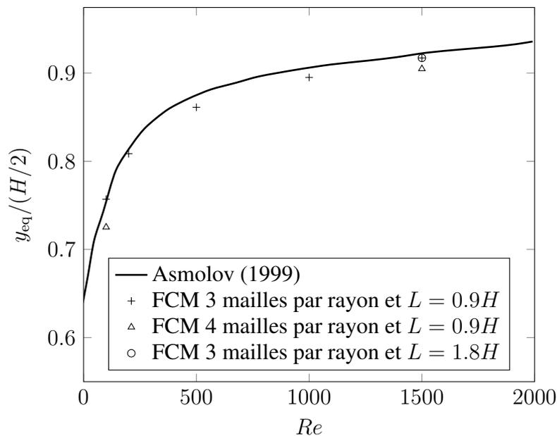
FIGURE 2.8: Positions d'équilibre pour différents nombres de Reynolds avec la FCM pour plusieurs résolutions et comparaison avec les résultats théoriques d'Asmolov (1999). La paroi est située à  $y_{eq}/(H/2) = 1$ , et le centre du canal est à  $y_{eq}/(H/2) = 0$
