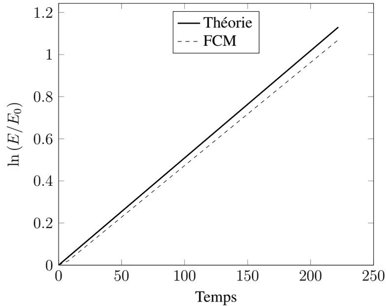
FIGURE 1.2: Évolution temporelle de l'énergie de la perturbation (normalisée par sa valeur initiale) à  $Re = 1/\nu = 7500$ .
