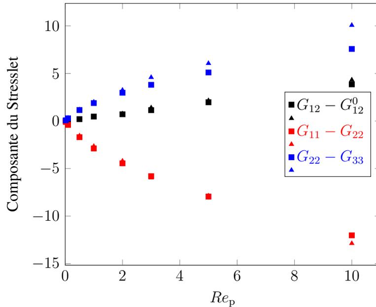
FIGURE 1.6: Composantes du Stresslet adimensionnalisées par  $\mu\gamma a^3$  en fonction de  $Re_p$ . En noir, déviation de la composante non-diagonale de cisaillement  $G_{12}$  par rapport à sa valeur à  $Re_p = 0$ . En rouge et bleu sont représentées les différences de contraintes normales. Les symboles ( $\square$  et  $\triangle$ ) représentent respectivement les résultats des simulations numériques directes de Mikulencak et Morris (2004) et ceux de la FCM.
