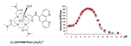
**Figure 35** - Structure du chémosenseur  $[Eu(\textbf{DOTAM-Phen})(H_2O)]^{3+}$  et graphique représentant la dépendance de la luminescence de l' $Eu^{3+}$  en fonction du pH.<sup>83</sup>
