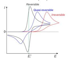
Figure 11 - Comparaison de voltamogrammes cycliques réversible, quasi-réversible et irréversible.
