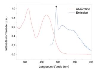
**Figure 154** - Spectres normalisés d'absorption (rouge) et d'émission (bleu) du complexe [CuL<sub>6</sub>]<sup>+</sup> ( $\lambda_{exc}$  = 400 nm) à température ambiante. \*Raman du dicholorométhane.
