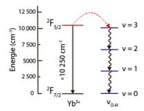
**Figure 56** - Représentation schématique de la transition  ${}^2F_{5/2} \rightarrow {}^2F_{7/2}$  de l'Yb<sup>3+</sup> et des vibrateurs O-H.
