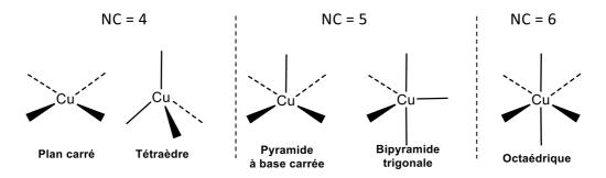
Figure 12 - Les différentes géométries des complexes de cuivre(II).
