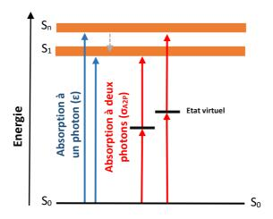
Figure 45 - Diagramme de Jablonski simplifié représentant le processus d'absorption à deux photons.
