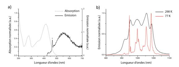
**Figure 60** – a) Spectres normalisés d'absorption (pointillé en gris) de [Yb(MeDO2PA-NPEG)]<sup>+</sup> et d'émission résiduelle (trait plein noir) de l'antenne sous excitation à 410 nm. b) Spectres normalisés d'émission de [Yb(MeDO2PA-NPEG)]<sup>+</sup> dans une solution MeOH-EtOH (v:v 4/1) à température ambiante (noir) et à 77 K (rouge) sous excitation à 410 nm. <sup>119</sup>
