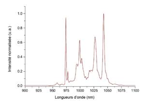
Figure 55 - Spectre d'émission de l'Yb3+ adapté de la référence. 113
