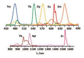
Figure 26 - Spectres d'émission des ions lanthanides en solution. 65
