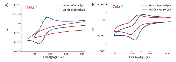
**Figure 110** - Voltamogrammes avant électrolyse (bleu) et après électrolyse (rouge) enregistrés à 0,1 V.s<sup>-1</sup> dans une solution H<sub>2</sub>O/LiClO<sub>4</sub> à pH 7 à a) -1,1 V pour le complexe [CuL<sub>2</sub>]<sup>+</sup> et b) -1,0 V pour le complexe [CuL<sub>3</sub>]<sup>+</sup>.
