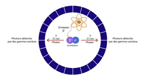
Figure 82 - Principe de l'imagerie TEP.
