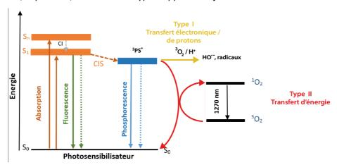
Figure 122 - Diagramme de Jablonski illustrant la génération d'oxygène singulet d'un photosensibilisateur.
