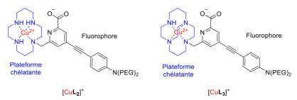
Figure 96 - Présentation des complexes de cuivre(II) cibles [CuL2]<sup>+</sup> et [CuL3]<sup>+</sup>.
