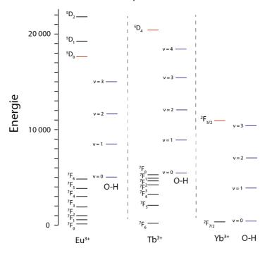
**Figure 29** - Comparaison des principaux niveaux luminescents (rouge) de l'Eu<sup>3+</sup>, du Tb<sup>3+</sup> et de l'Yb<sup>3+</sup> et le nombre d'oscillateurs OH (bleu) pour les inhiber.
