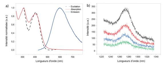
**Figure 153** - a) Spectres normalisés d'absorption, d'excitation et d'émission du composé **29** ( $\lambda_{exc}$  = 400 nm) et b) spectres d'émission résultant de la génération d'oxygène singulet à différents absorbances (entre 0,01 et 0,1) dans l'IR ( $\lambda_{exc}$  = 400 nm, droite) à température ambiante.
