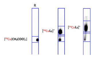
Figure 113 - Radio-CCM des composés [ $^{64}$ Cu(CH $_{3}$ COO) $_{2}$ ], [ $^{Cu}$ L $_{2}$ ] $^{+}$  et [ $^{Cu}$ L $_{3}$ ] $^{+}$  (30 min, 100°C, DMSO). R = Référence.
