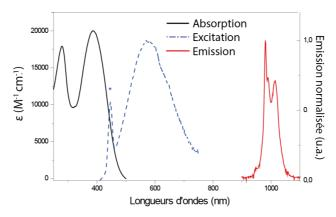
Figure 77 – Spectre d'abosrption et d'emission du complexe  $[YbL_1]^+$  dans l'eau à température ambiante. Absorption (trait plein noir), émission résiduelle de la bande ILCT du ligand (pointillés bleus), émission dans la région NIR centrée sur la transition  ${}^2F_{5/2} \rightarrow {}^2F_{7/2}$  de l'ion  $Yb^{3+}$ .
