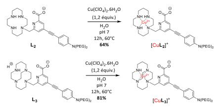
Figure 109 - Synthèse des complexes de cuivre(II) [CuL<sub>2</sub>]<sup>+</sup> et [CuL<sub>3</sub>]<sup>+</sup>.
