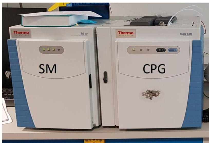
Figure I-21 : Chromatographe en phase gazeuse (CPG) couplé à un spectromètre de masse (SM) au laboratoire
