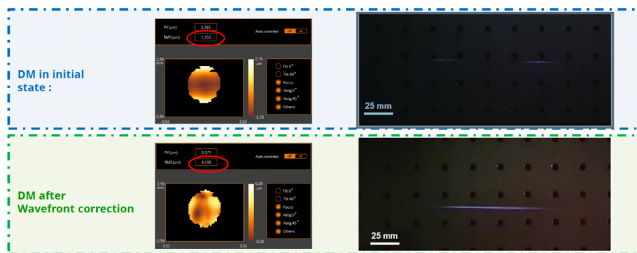
FIGURE 1.20: Canaux plasma observés lors du test préliminaire à DTU (Haut) sans et (Bas) avec la correction du front d'onde laser par un miroir déformable.
