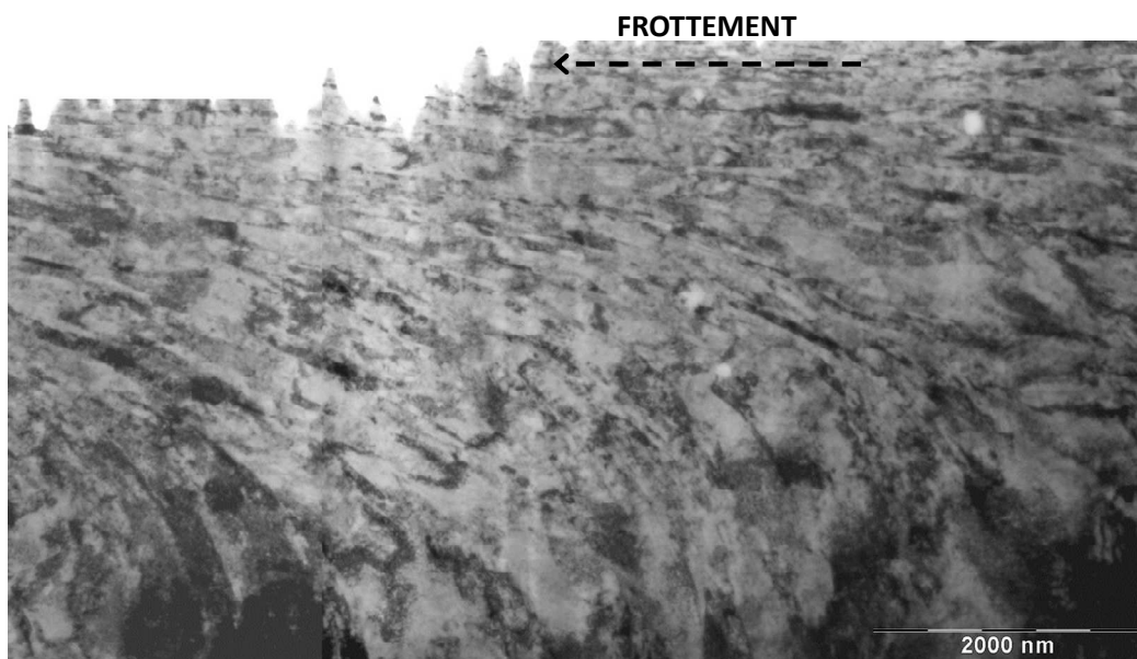
Figure 34 : Observation MET en extrême surface d'un pion après 1 h de frottement à 700°C.
