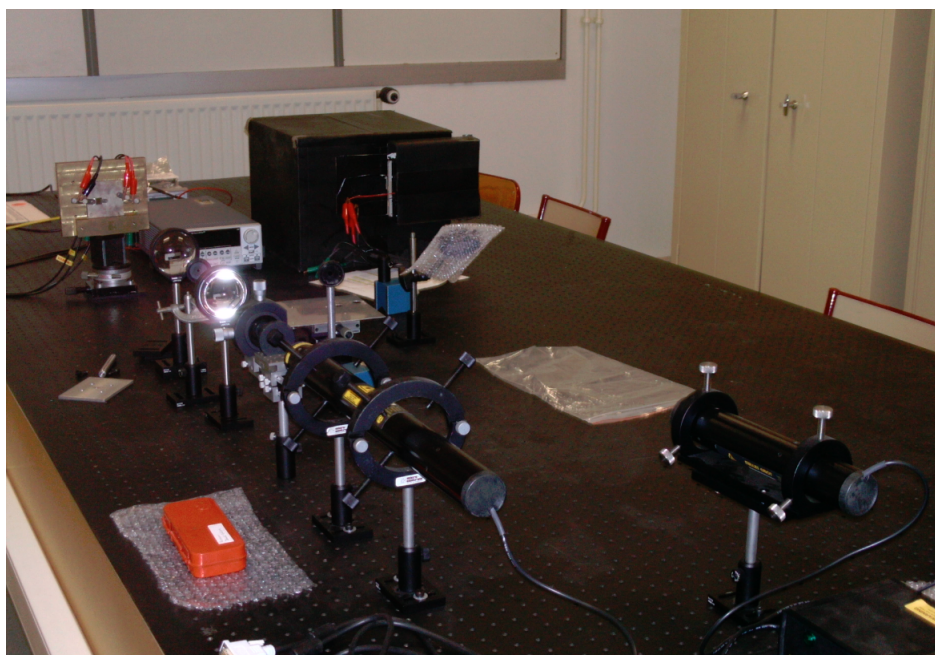
FIGURE 4.15 – Photographie du montage utilisé pour les mesures d'EQE et d'IQE au laboratoire des systèmes photoniques.
