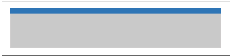
FIGURE 6.4 – Etape 3 : Implantation de phosphore dans le wafer à une énergie de 107 keV.
