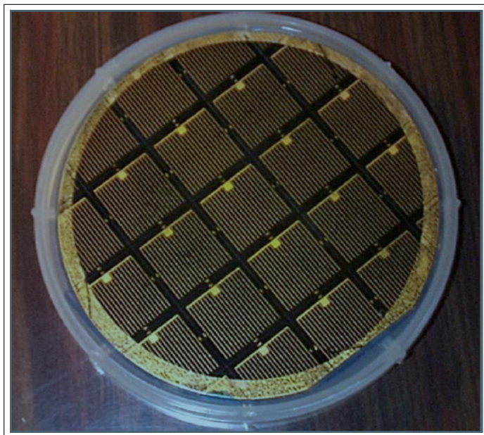
FIGURE 1.2 – Photographie d'un wafer complet des échantillons type MIND première génération [24].
