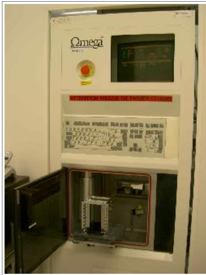
FIGURE 4.2 – photographie du graveur AVIZA TECHNOLOGY OMEGA201 [2]
