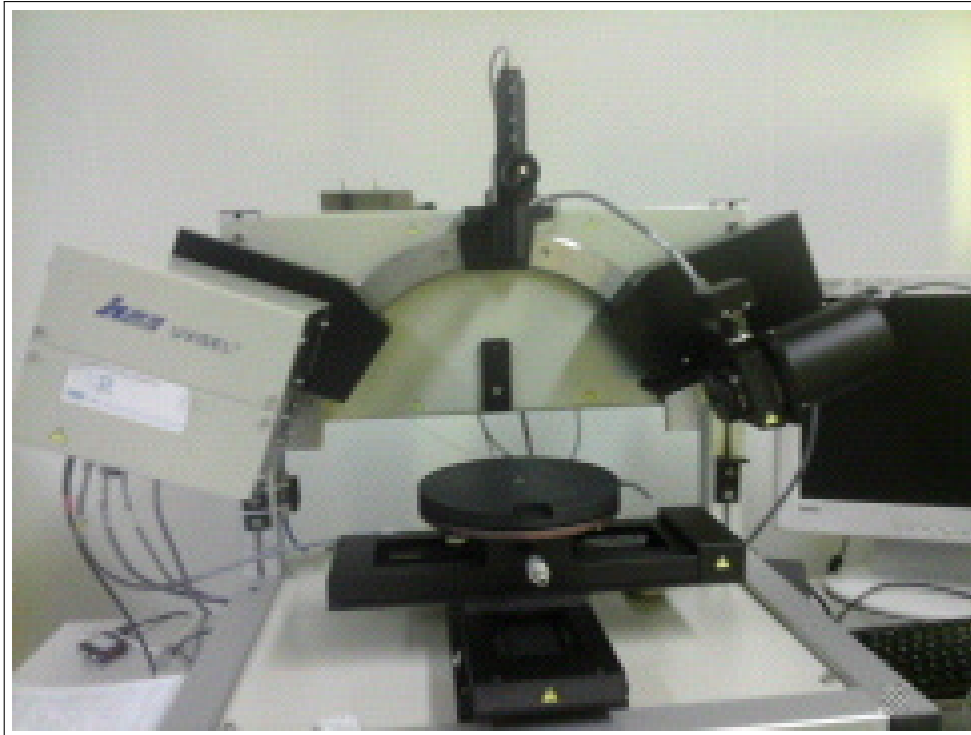
FIGURE 6.11 – Photographie de l'ellipsomètre utilisé au LAAS
