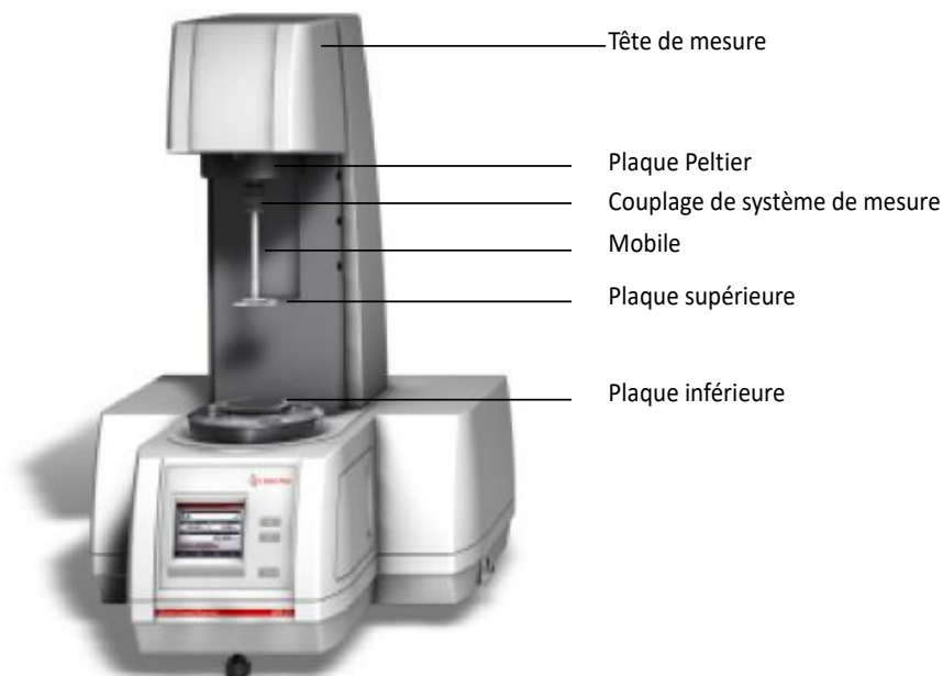
Figure 13. Exemple de rhéomètre similaire à celui utilisé dans ce travail : il est relié à un ordinateur pour le traitement des données (d'après Anton-Paar).
