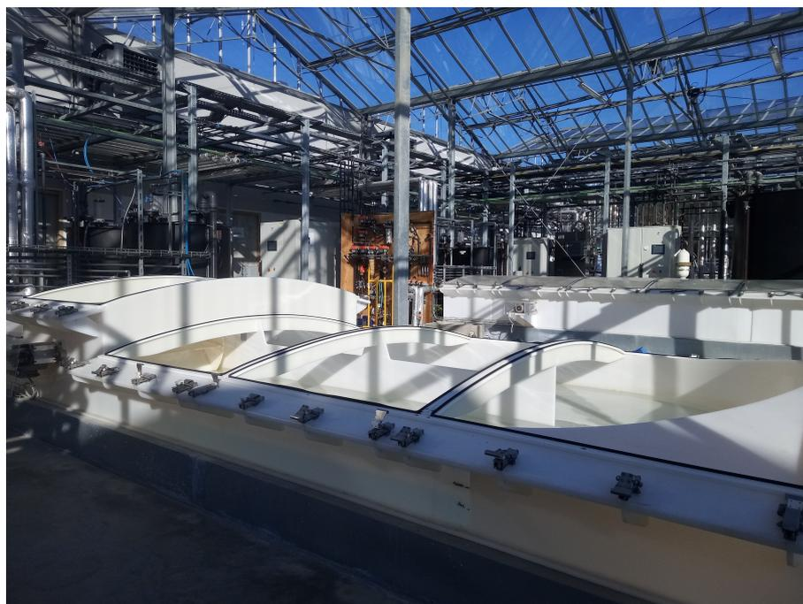
FIGURE 1.2 – Photographie d'un raceway ouvert installé sous la serre de la plateforme Algosolis.
