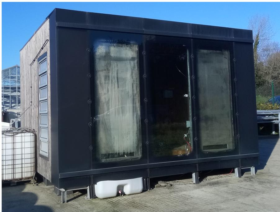
FIGURE 1.3 – Photographie du pilote SymbiO<sub>2</sub>Box implanté sur la plateforme Algosolis. Deux réacteurs airlift plans sont installés plein sud sur la façade. La partie se trouvant derrière permet de simuler la présence d'un bâtiment et d'étudier le couplage PBR - bâtiment.
