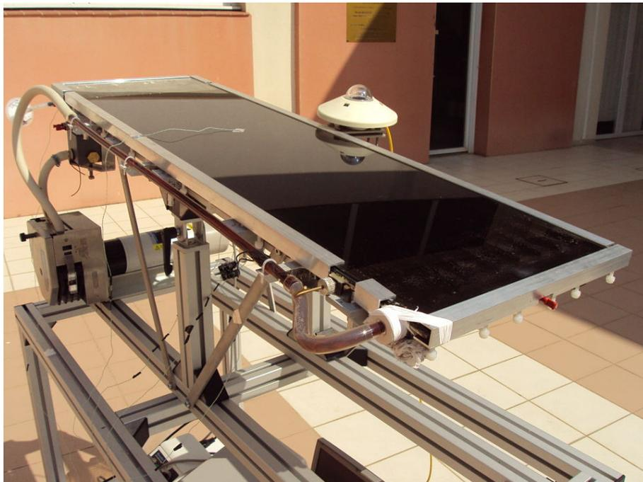
FIGURE 1.7 – Photographie du prototype Algofilm 0.33 m<sup>2</sup> (Le Borgne 2011).
