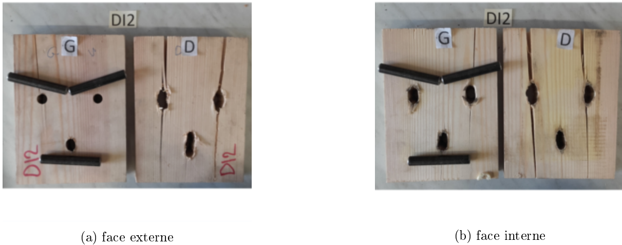
FIGURE 2.17 – Profil de rupture pour un essai cyclique axial sur assemblage (échelle 1, éprouvette DI2 ), aucune déformation des broches visible
