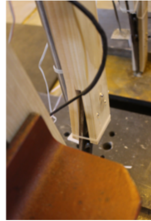
(b) Flexion hors plan en pied de diagonale, échelle 1/3, éprouvette 2
