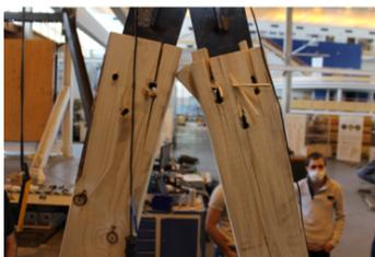
(c) éprouvette 2 : rupture par traction perpendiculaire au fil en tête des diagonales
