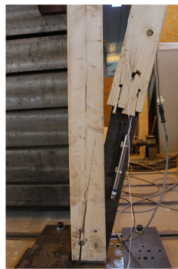
(a) éprouvette 1 : rupture par traction perpendiculaire au fil en pied de poteau
