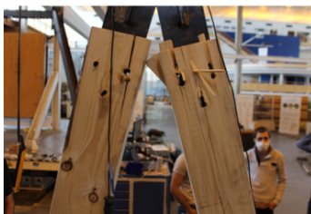
(c) éprouvette 2 : rupture par traction perpendiculaire au fil en tête des diagonales
