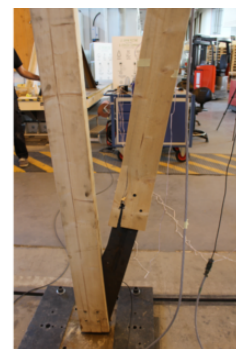
(d) éprouvette 3 : rupture par traction perpendiculaire au fil en pied de diagonale
