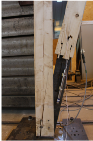
(a) Rupture fragile en pied de poteau et de la diagonale, échelle 1, éprouvette 1
