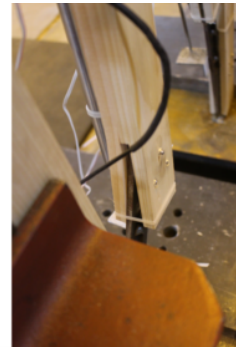
(b) éprouvette 2 : flexion hors plan de la pièce métallique en pied de diagonale
