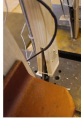
(b) Flexion hors plan en pied de diagonale, échelle 1/3, éprouvette 2
