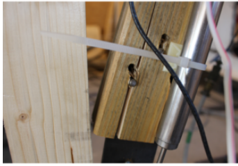
(a) éprouvette 1 : rupture par traction perpendiculaire au fil en pied de diagonale
