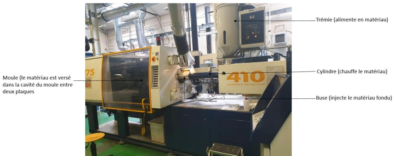
Figure 37 - Presse à injection DK CODIM 175 du PIMM
