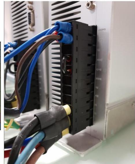
Figure 79 - Raccord du câble d'alimentation 24V
