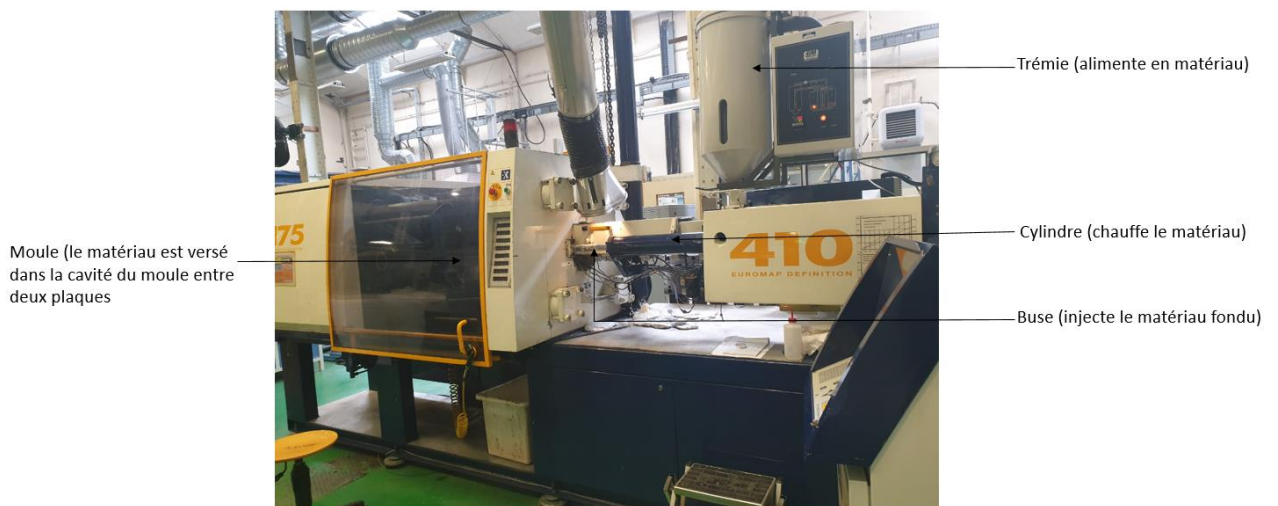
Figure 37 - Presse à injection DK CODIM 175 du PIMM
