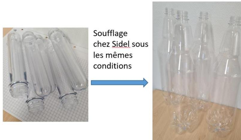
Figure 65- Soufflage des bouteilles SIDEL
