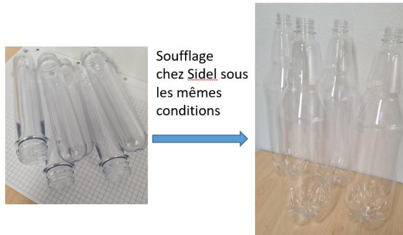
Figure 65- Soufflage des bouteilles SIDEL
