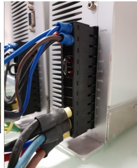
Figure 79 - Raccord du câble d'alimentation 24V
