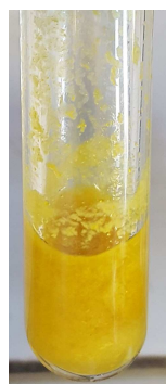
Figure 36 - Photo du tube de réaction après chauffage par micro-onde montrant une possible polymérisation du dérivé 4- N,N -diméthylvinylaniline.
