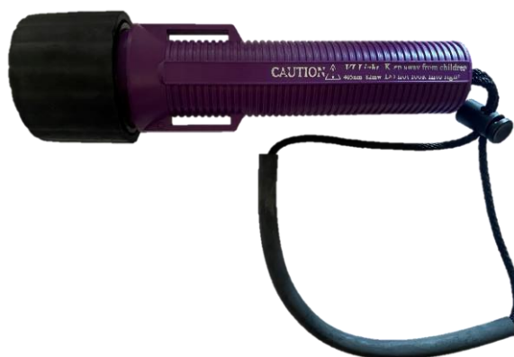
Figure 3 : Lampe VI (Northwest Marine Technology), immergeable, diffusant une lumière violette ( \lambda = 405 \text{ nm} ) qui fluoresce les implants d'élastomère
