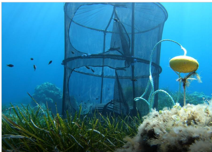
Figure 13 : Cage anti prédation (V = 6000 L) lors de l'ouverture avec présence des refuges au fond de la cage (relâché expérimental des juvéniles de corbs de l'année 2021)
