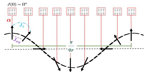
Figure 6.4: Schéma de la phase dissipative. Les flèches noires désignent les spins et les boîtes rouges les bains dissipatifs de Caldeira-Leggett. La phase dissipative est un SDW sans gap avec un ordre à longue portée avec une périodicité  $\pi/q_F$ .
