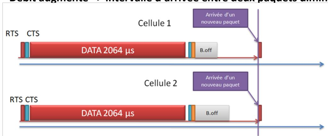
**Figure 5.20 : Cycle CSMA/CA et intervalle d'arrivée des paquets**
