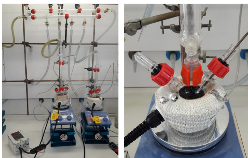
Figure 1 : Dispositif expérimental utilisé pour les synthèses de nanoparticules de cuivre et la sulfuration des nanoparticules de cuivre décrites aux Chapitre 2,3 et 4
