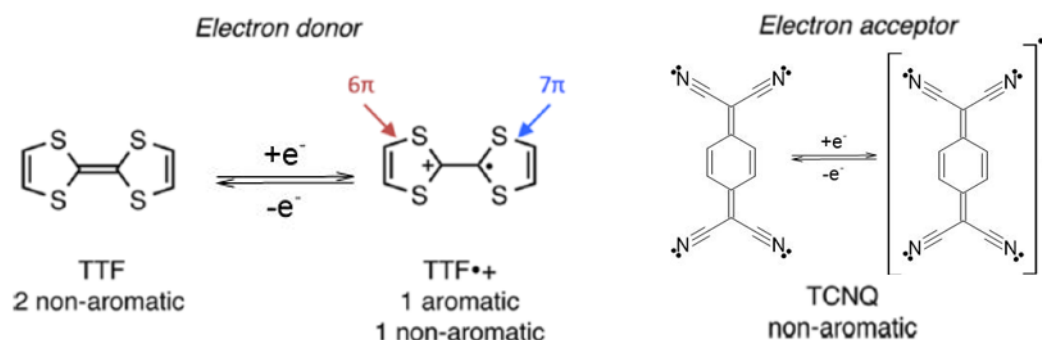
FIGURE 4.3 – réaction d’oxydoréduction du TTF et de la TCNQ lors de la synthèse du complexe TTF-TCNQ
