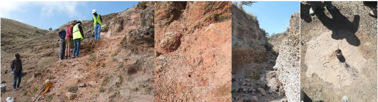
Figure 46 - Photos de terrain des sites 25 à 29 (gauche ; mesure au BIOGAS 5000 en compagnie de Jacques Varet et une partie de l'équipe TMGO en charge du forage de Tulu Moyo), 26 (centre gauche ; zoom sur une des fumerolles dans des argiles hydrothermales types smectites), 30 (centre droite ; fracture ouverte inactive) et 31 (droite ; puits de gradient de température du site de Tulu Moyo)
