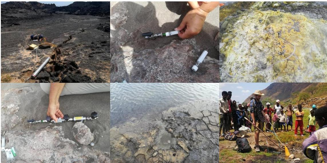
*Figure 14 - Photos prises lors de différents prélèvements sur le terrain. Echantillonnages de gaz majeurs, rares. Mesures dans des fumerolles et bullages.*
