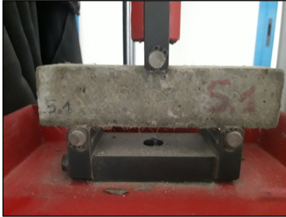
Figure 2.21: Éprouvette de composite sous essai de flexion
