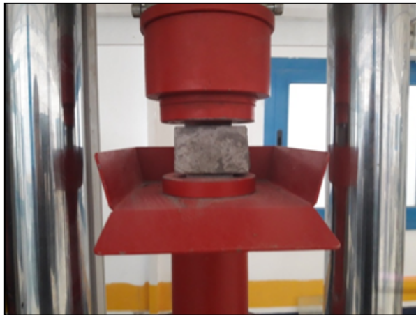
Figure 2.22: Éprouvette de composite sous essai de compression
