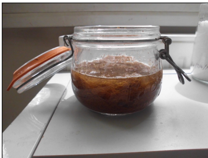
Figure 2.5: Fibres de Posidonia-Oceanica dans une solution de soude
