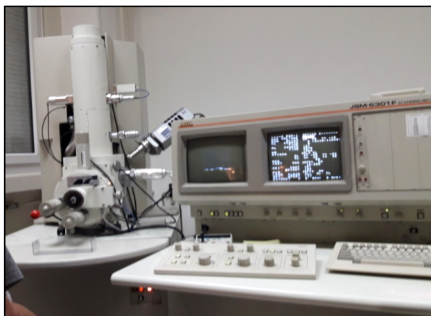
Figure 2.12: Microscope électronique à balayage JEOL 6301F
