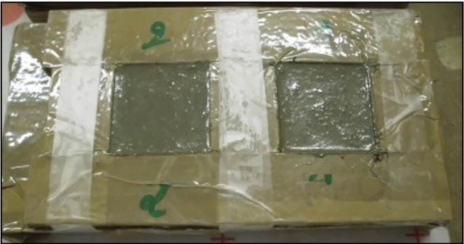
Figure 2.9: Éprouvettes pour essais thermiques et hygrothermiques
