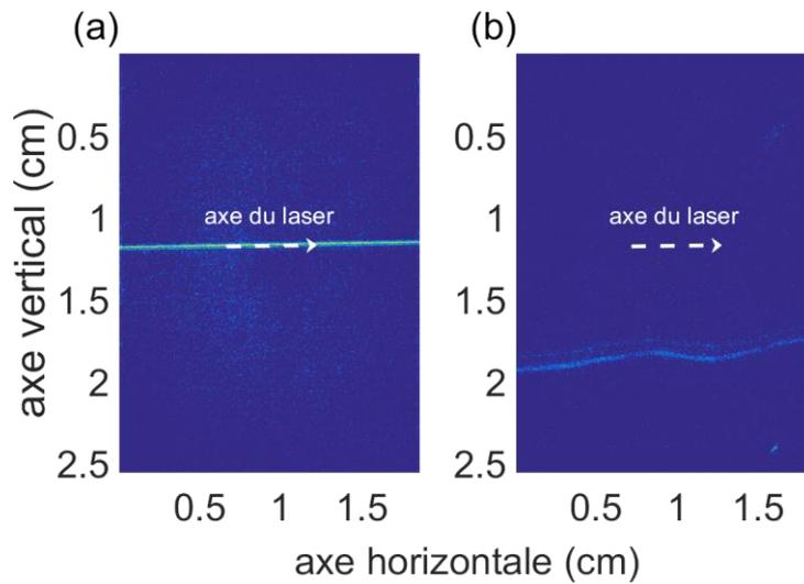
**Figure 4** : Mesure par strioscopie du chemin emprunté par deux décharges guidées par laser consécutives réalisées à 10 Hz. La première décharge est guidée et suit le chemin du laser (a) alors que la seconde décharge ne l'est pas et suit un chemin aléatoire (b).
