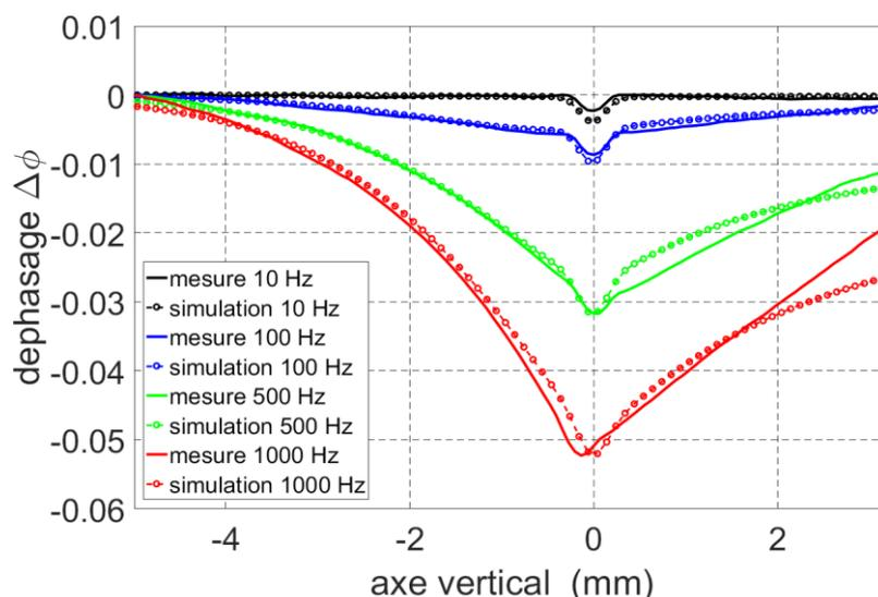
**Figure 3** : Mesures du déphasage induit par la variation de densité générée par filamentation laser à différentes cadences. On observe pour des cadences  $\geq 100$  Hz un déphasage plus grand et présent sur une zone bien plus étendue qu'à 10 Hz, caractéristique d'un canal sous dense plus important.
