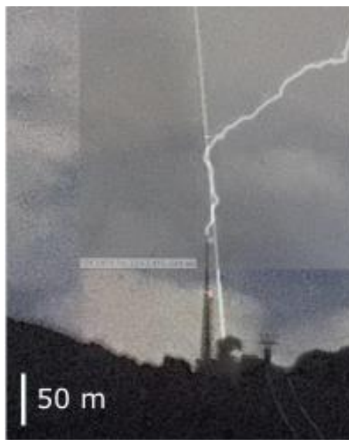
Figure 6 : Image capturée par une caméra rapide de la propagation d'un des éclairs observés en présence de filaments laser. Une photo prise du même angle de vue que la caméra et montrant la trajectoire du laser y est superposée, mettant en évidence le phénomène de guidage.
