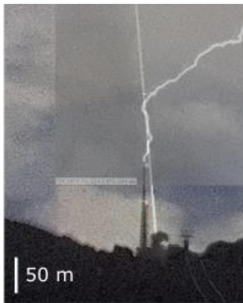
**Figure 6** : Image capturée par une caméra rapide de la propagation d'un des éclairs observés en présence de filaments laser. Une photo prise du même angle de vue que la caméra et montrant la trajectoire du laser y est superposée, mettant en évidence le phénomène de guidage.
