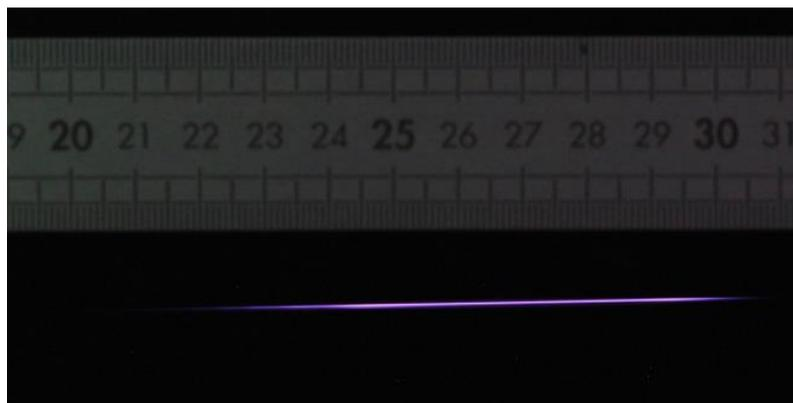
**Figure 2** : Photo du premier filament observé lors de ma thèse, créé par une impulsion laser de 2.5 mJ d'énergie, d'une durée de 50 fs à la longueur d'onde de 800 nm. La lumière observée provient de la luminescence du plasma.
