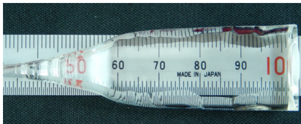
FIGURE 2.2 – Croissance d'un cristal CTAS incolore par la méthode de Czochralski d'après [50].
