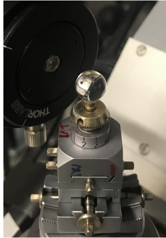
FIGURE 2.10 – Sphère de CTAS de diamètre D = 8,45 mm collée orientée sur une tête goniométrique pour une rotation sans précession.
