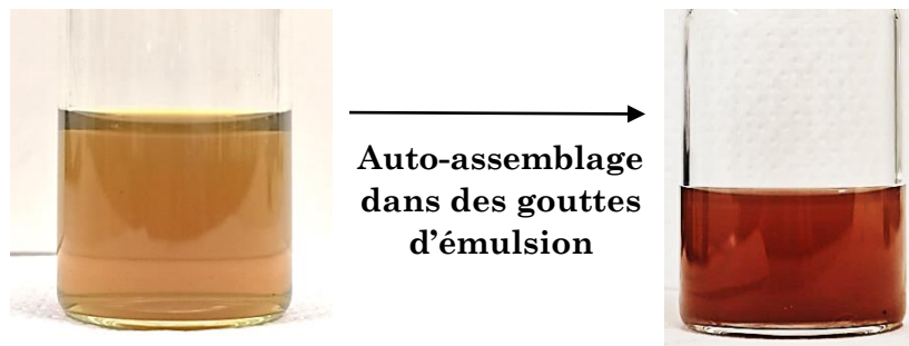
Figure 3.8 : Photographies d'une dispersion initiale de nanoparticules d'Ag-PVP individuelles (à gauche) et de la dispersion finale de clusters qui a été obtenue après émulsification de cette dernière et évaporation de la phase aqueuse (à droite).
