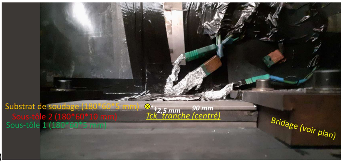
Figure 56 : (a)(b) montage et positionnement des thermocouples sur le substrat lors de la fabrication du mur en TA6V de Type-P3
