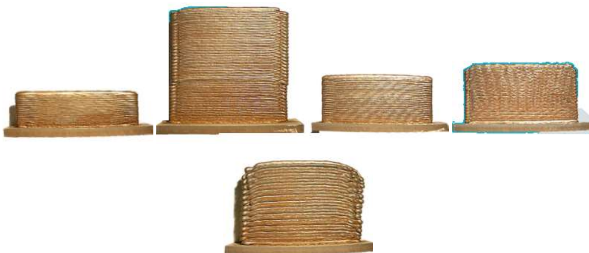
Figure 62 : photos des murs en 316L produits avec les paramètres de Type-P1 à -P5 de droite à gauche
