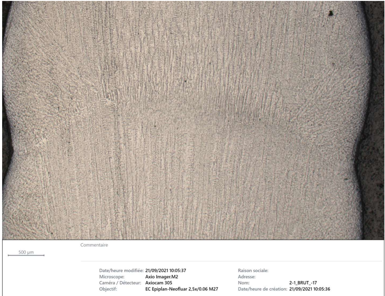
Figure 145 : micrographie d'une coupe transversale d'un mur Type-P2-inerté
