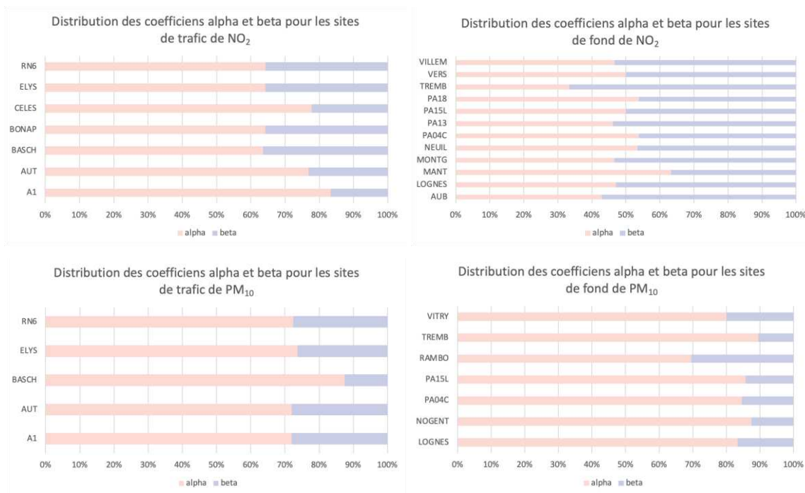
Figure 30 - Contribution des coefficients \alpha et \beta à k , en pourcentage, pour les stations de trafic (à gauche) et de fond (à droite) des jeux d'apprentissage du \text{NO}_2 (en haut) et des \text{PM}_{10} (en bas) pour l'année 2017.
