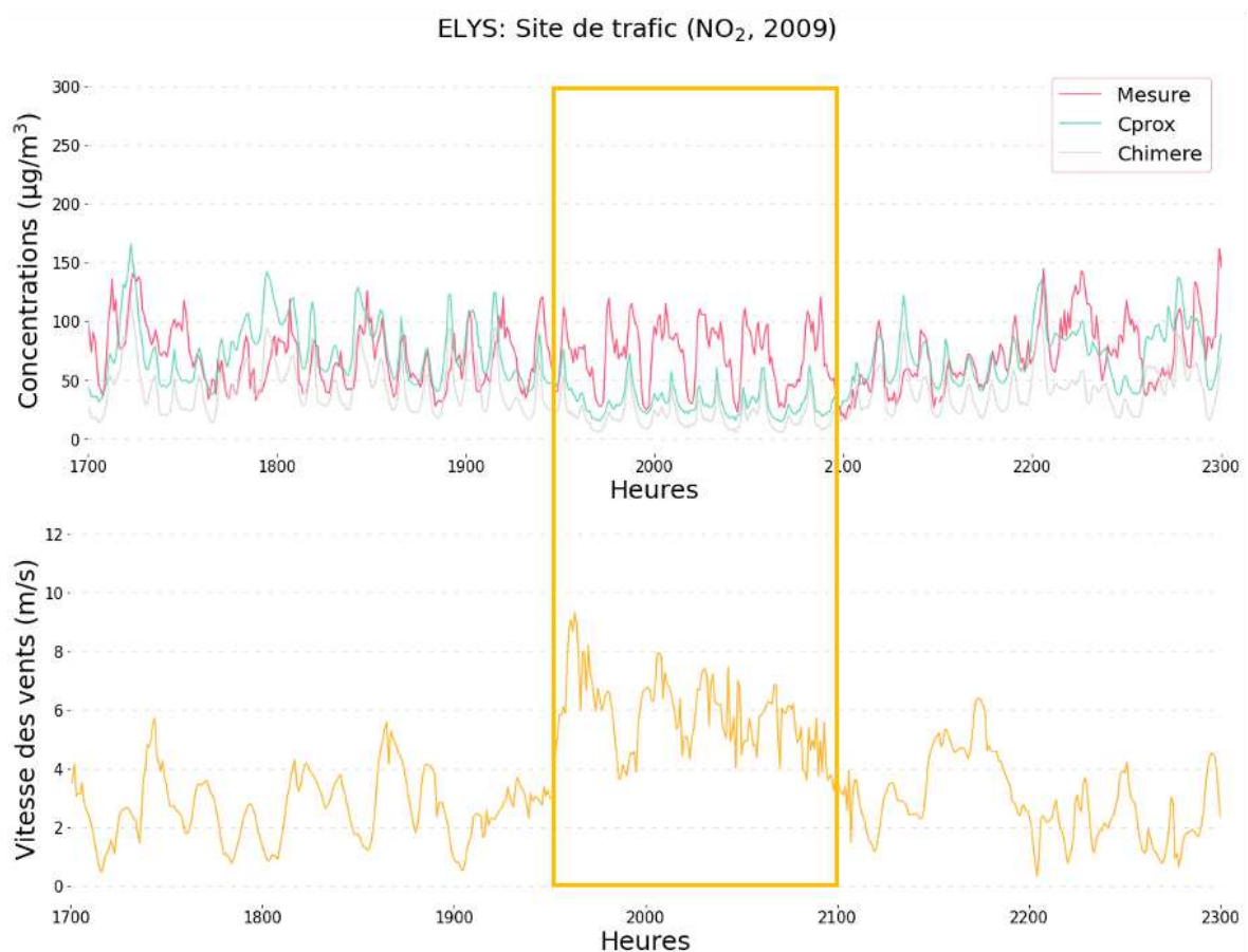
Figure 8 – Coïncidence entre les périodes de mauvaise restitution des concentrations (ici de NO 2 , en µg/m 3 ) par CHIMERE et par Cprox , et la vitesse du vent issue de WRF, sur le site de trafic des Champs-Élysées pendant le mois de mars 2009.
