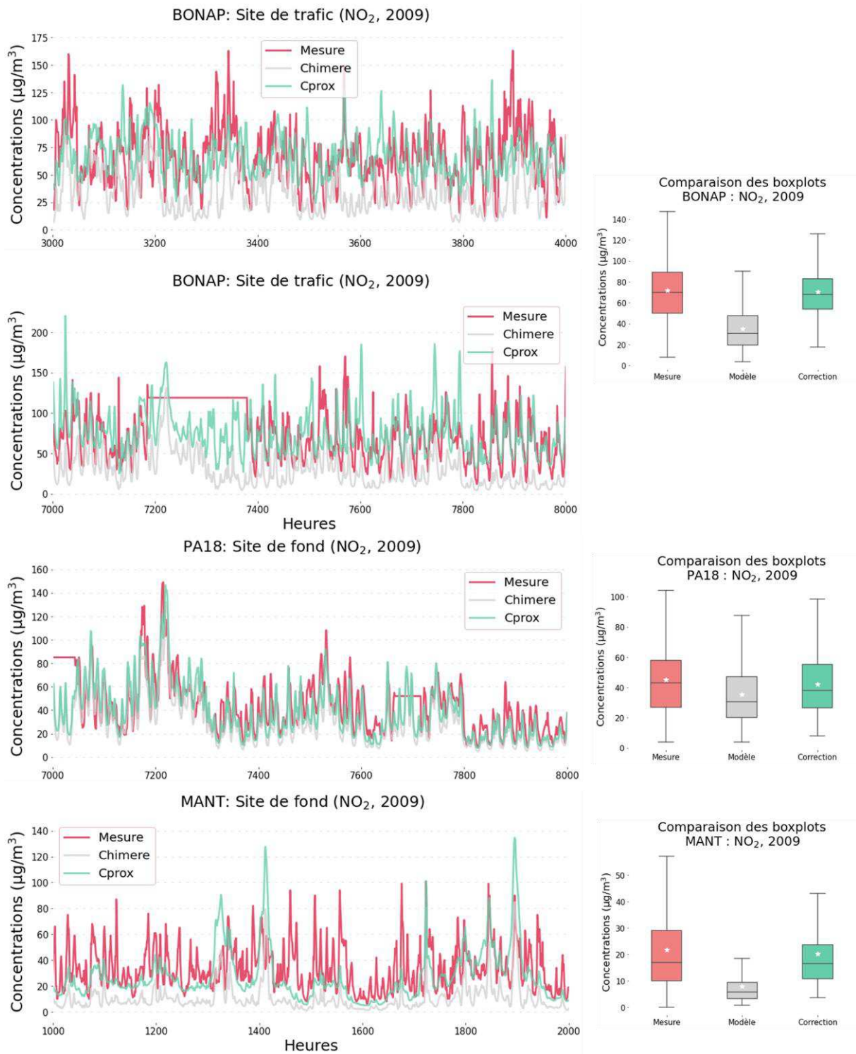
Figure 11.a - Comparaison des séries temporelles de CHIMERE (en gris), de Cprox (en vert) et de la mesure (en rouge) pour NO 2 , en µg/m 3 , sur des périodes d'environ 1 mois durant l'année 2009. A droite des séries temporelles, des boîtes à moustache (même code couleur) montrent les minima, maxima, percentiles 25 et 75, moyenne et médiane de chaque série de données sur l'ensemble de l'année 2009.
