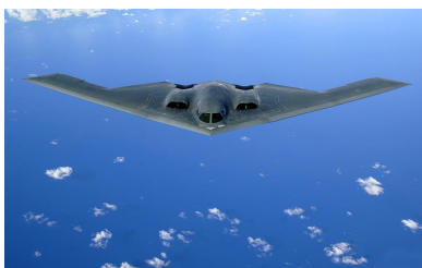
FIGURE 1.1 – Photographie d'un bombardier furtif [1] pour illustrer les contre-mesures passives. La forme de l'avion en "aile volante" diffère de la forme standard des bombardiers et des avions de chasse.
