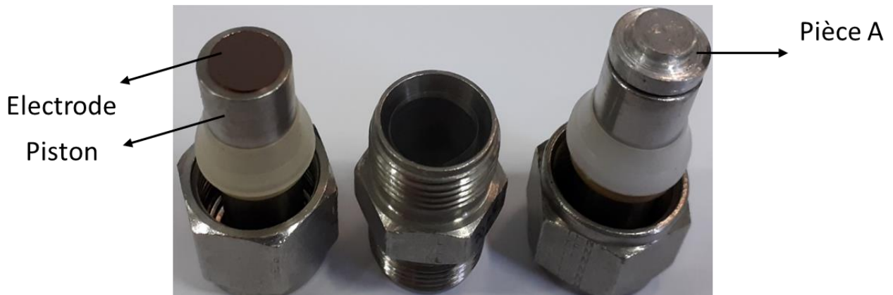
Figure 2. 6: Photo d'un assemblage en Swagelok pour une mesure de la résistivité à deux pointes.
