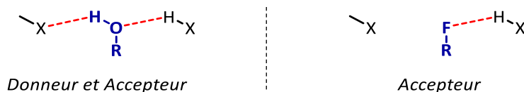
Figure 3. Comparaison des liaisons hydrogène entre un groupement hydroxyle et l'atome de fluor.
