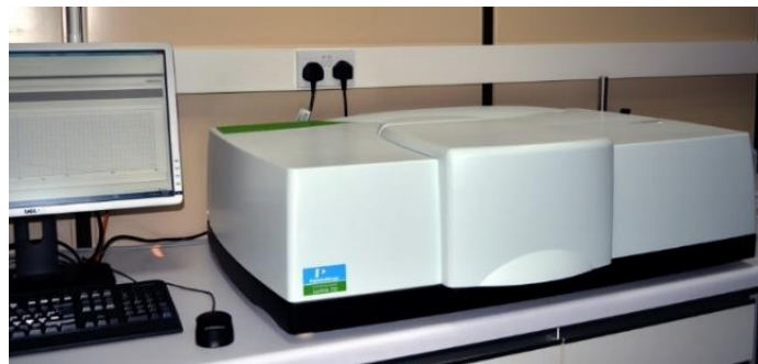
Figure III.18 : Photo du spectromètre Perkin Elmer Lambda 750.
