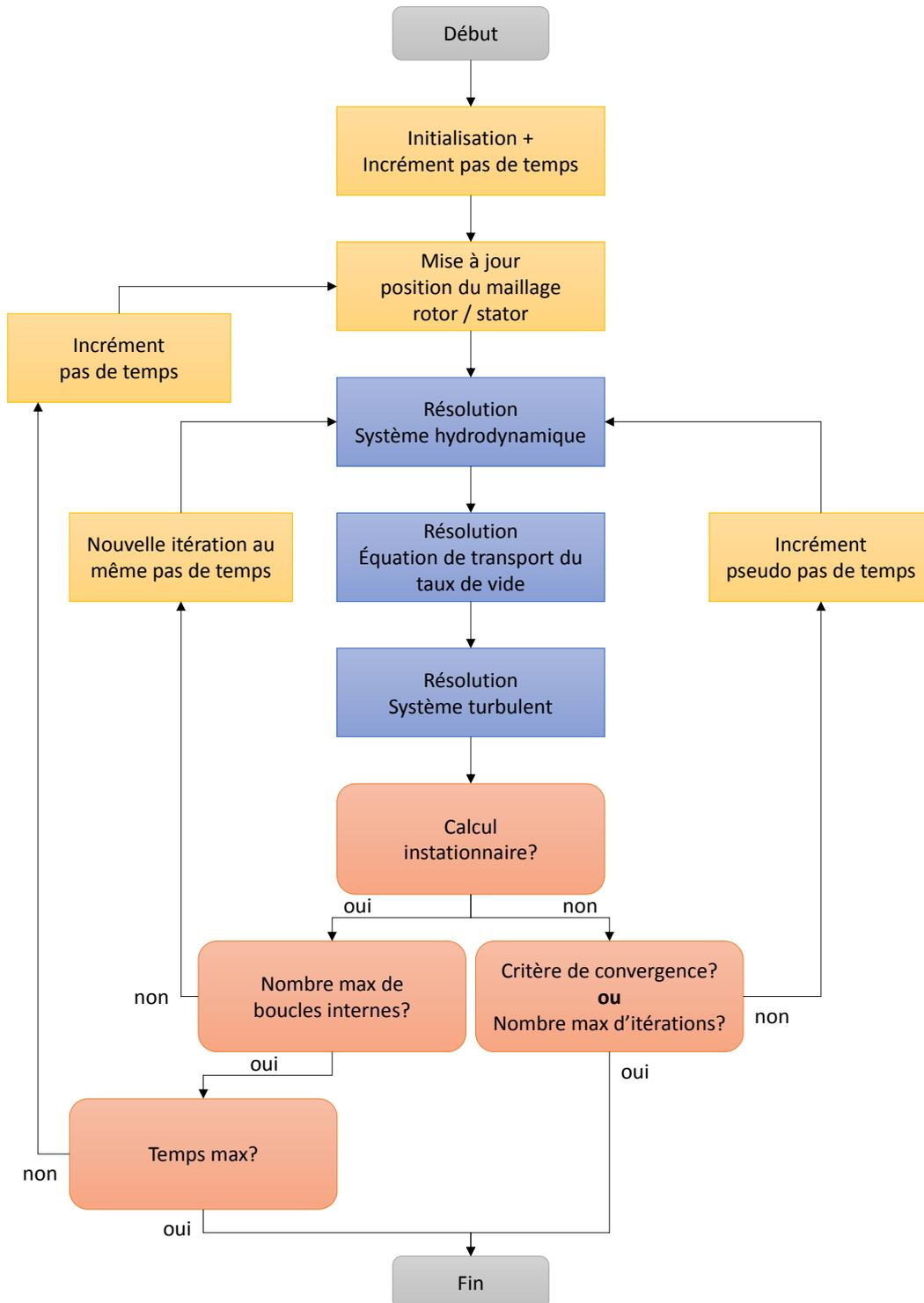
Figure 3.4 – Procédure de résolution simplifiée de CFX [7]
