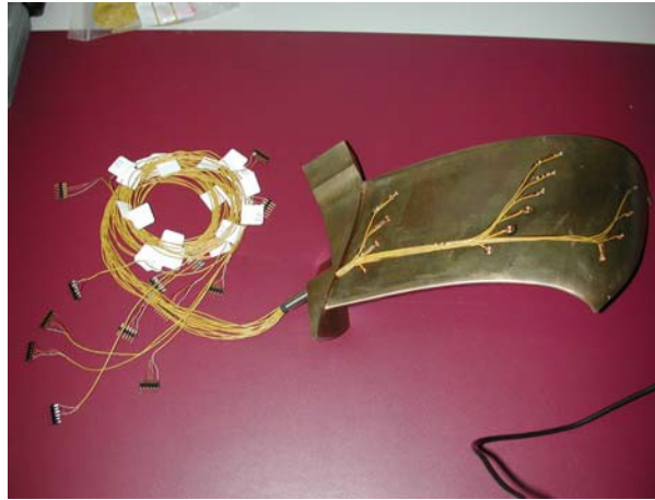
Figure 2.6 – Exemple d'aube instrumentée en capteurs de pression [40]
