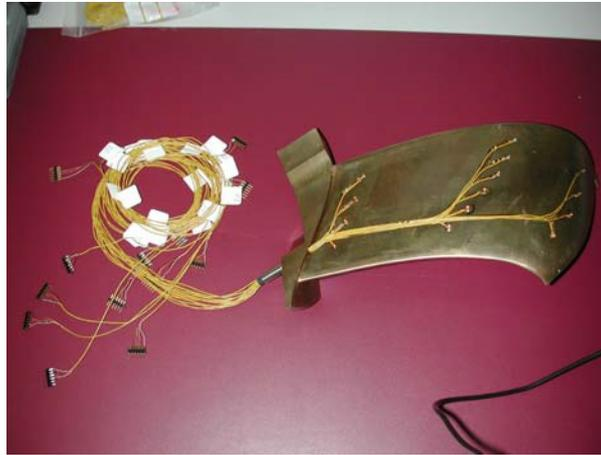
Figure 2.6 – Exemple d'aube instrumentée en capteurs de pression [40]
