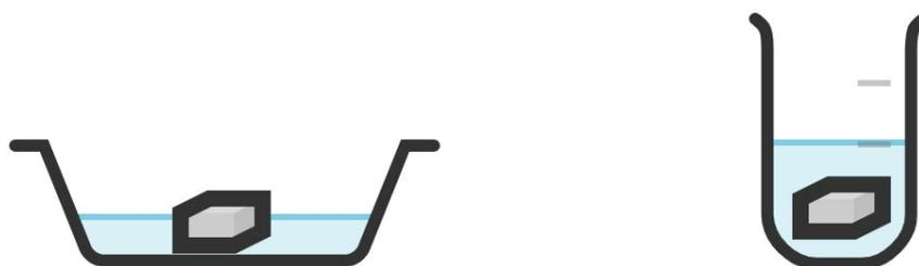
Figure 34 Deux récipients utilisés pour la préparation de matrice {coton/La(NO<sub>3</sub>)<sub>3</sub>} : gauche : matrice dans une coupelle en aluminium; droit : matrice dans un bécher
