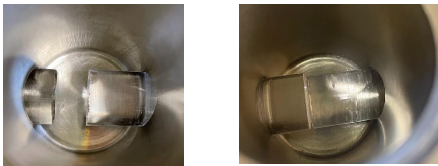
Figure 18 Cylindres en verre permettant de diminuer la longueur optique (jusqu'à 1 mm)
