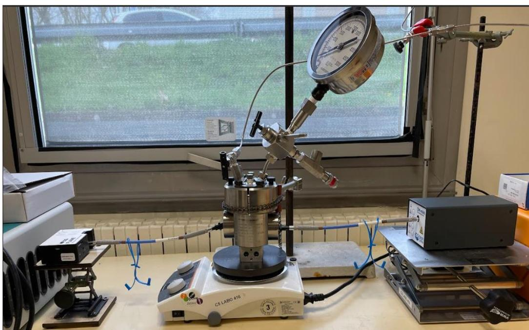
Figure 28 Dispositif pour étudier la solubilité en ScCO<sub>2</sub> couplé un spectroscopie UV-Vis
