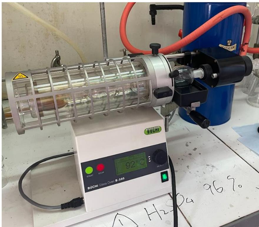
Figure 26 Dispositif de la distillation boule à boule : four à boule Buchi B585, tube à boule (V = 20 mL) et piège azote liquide
