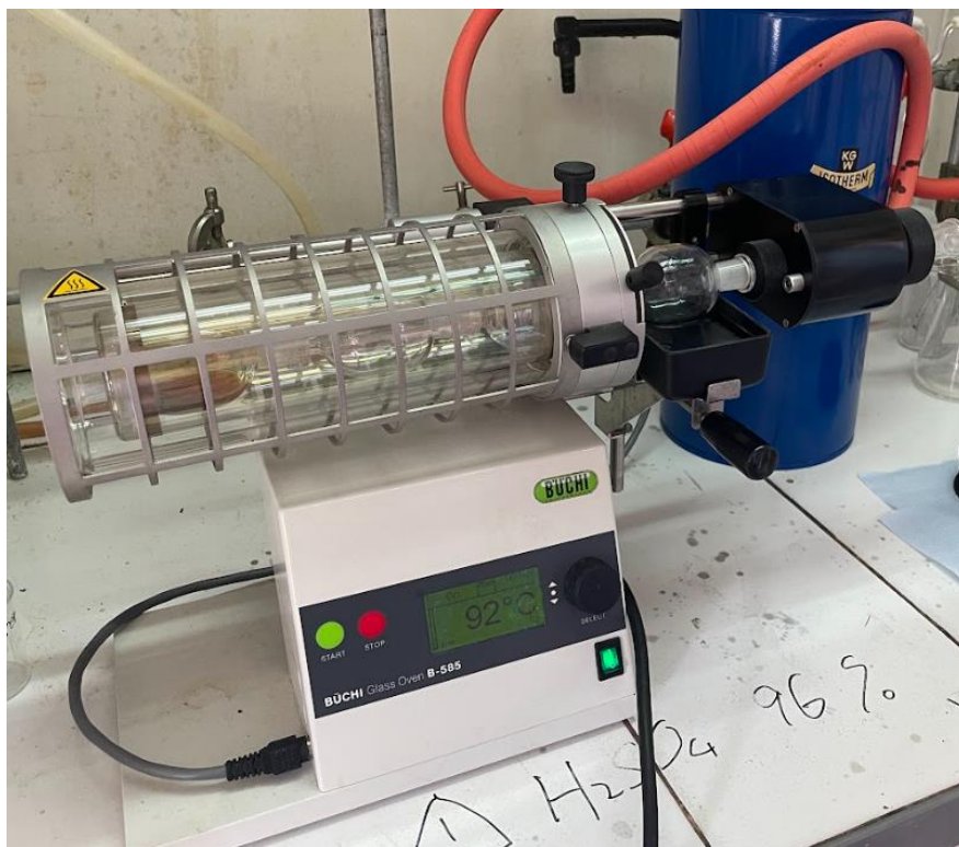
Figure 26 Dispositif de la distillation boule à boule : four à boule Buchi B585, tube à boule (V = 20 mL) et piège azote liquide
