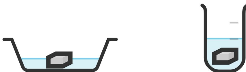
Figure 34 Deux récipients utilisés pour la préparation de matrice {coton/La(NO 3 ) 3 } : gauche : matrice dans une coupelle en aluminium; droit : matrice dans un bécher
