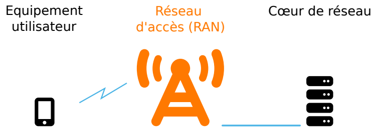
FIGURE 2.1 – Schéma des éléments d'un réseau mobile.
