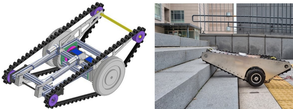
FIGURE 2.5 – Mécanisme de fauteuil roulant pour monter les escaliers [22]
