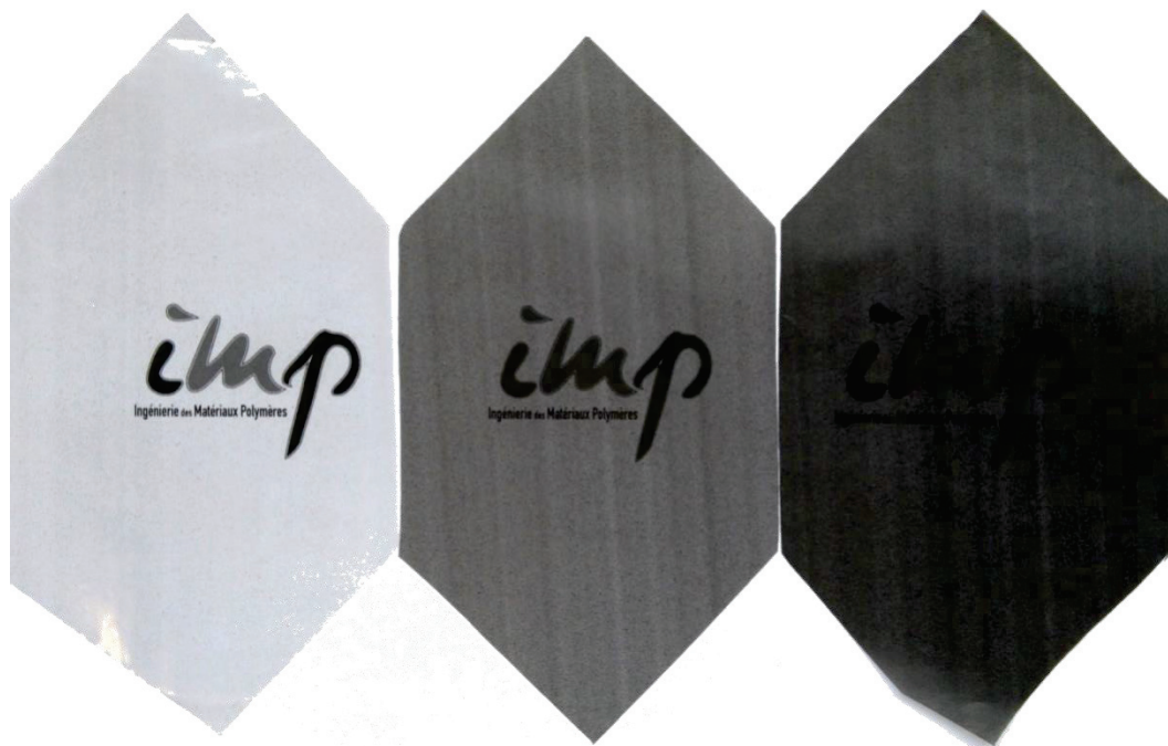
Figure V-22 : Observation de l'aspect visuel de monocouches EVOH/CT1 contenant (de gauche à droite) 0,4 %massique, 2 %massique et 4 %massique de charges ( T = 25\text{ }^{\circ}\text{C} , e = 20\text{ }\mu\text{m} , \sigma_w = \text{ambiante} )
