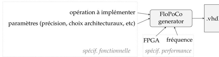
FIGURE 3.12: L'interface typique d'un générateur d'opérateurs dans FloPoCo [152]
