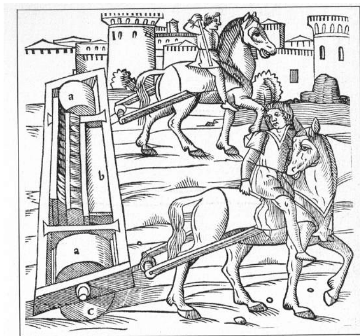
Fig. 61 : Machine pour déplacer des colonnes, représentée dans la traduction du De l'architecture de Vitruve de Jean Martin
